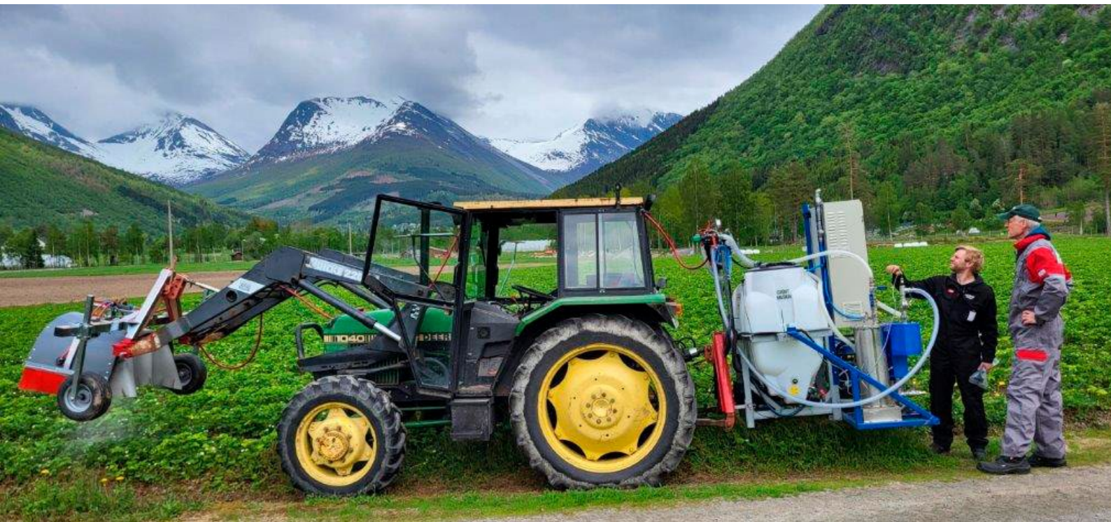
Traktor med ozongenerator for behandling av jordbær.
